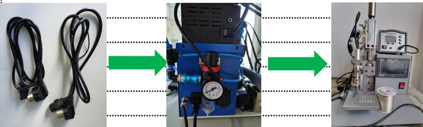
5.5、打开气阀, 打开电源, 进入操作设置.
